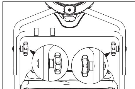
➔ Pousser la moitié supérieure de l'étrier de poussée sur la moitié inférieure de l'étrier de poussée.
